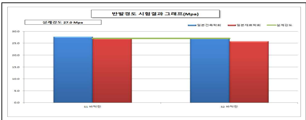
【그림 1.4.5】 영천방향 상부구조 반발경도시험 측정결과
